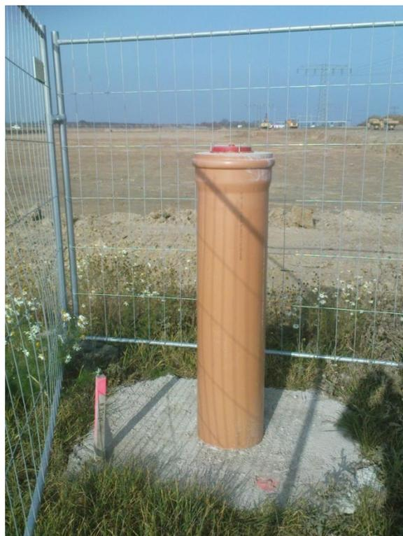
**Abbildung 8: Messsäule, bestehend aus einer Messingplatte auf einem mit Beton gefüllten Rohr, das in einem 1 Kubikmeter großen Betonfundament verankert ist**
